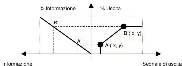
Nella parte sinistra del grafico troviamo una retta passante per l'origine che identifica l'andamento dell'informazione da 0 al 100%; nella parte destra del grafico troviamo una retta che identifica la caratteristica del segnale di uscita (PWM) in base al relativo valore dell'informazione di ingresso.
