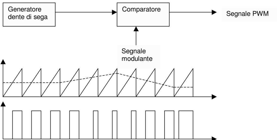
Una forma d'onda a dente di sega è applicata al comparatore, il cui livello di soglia è funzione del segnale modulante e quindi lo sarà anche la durata degli impulsi all'uscita del comparatore; la demodulazione può essere ottenuta applicando il segnale PWM ad un filtro passa basso.
